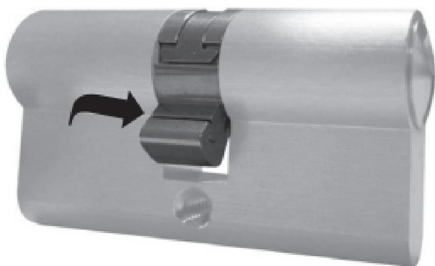
Bei Zylinder, die konstruktionsbedingt eine geteilte Schließnase haben, muss die Montagekante (s. Pfeil) zum Türband hin zeigend montiert werden, da sonst eine Fehlfunktion nicht ausgeschlossen werden kann.
