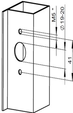
Die Profilbohrung für die Stangenführung & die Befestigungslöcher M5 einbringen
